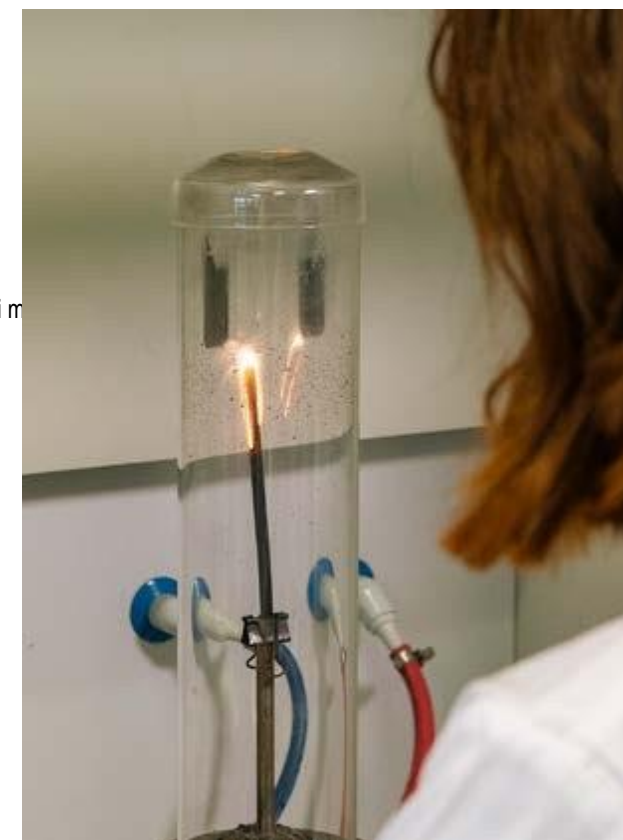
Test dell'indice di ossigeno, per valutare l'infiammabilità di un materiale in base alla percentuale di ossigeno presente.
